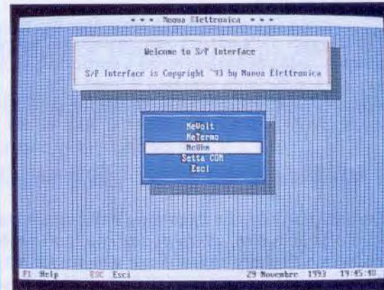
Fig.18 Se dopo aver posto il cursore sulla scritta NEOHM e premuto Enter il programma non parte, resettate il computer e caricate il programma con C:\LX1127>LX1127.
