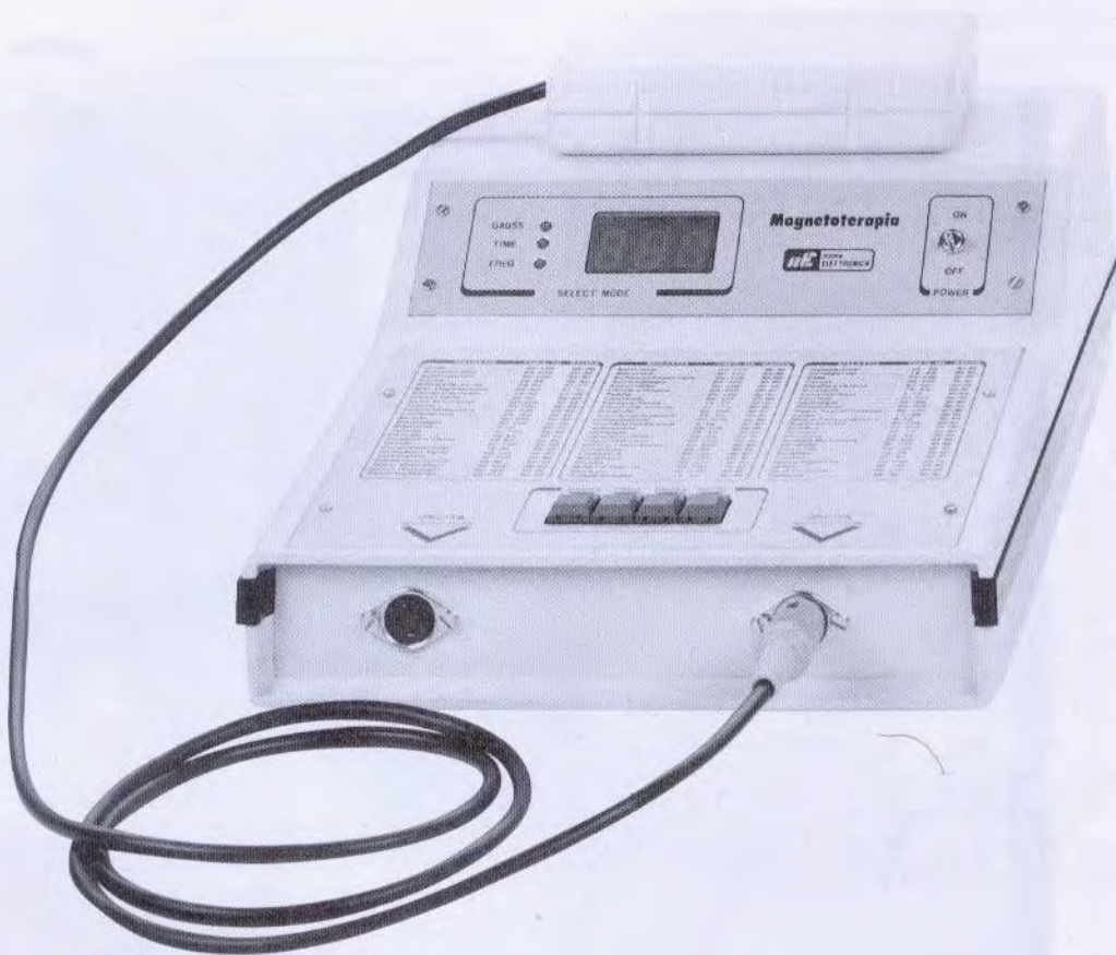
Fig.11 Per individuare la polarità del campo magnetico sarà sufficiente appoggiare il Diffusore Magnetico sul mobile. Se dal lato di contatto esce il flusso "positivo" sul display apparirà il segno +, se capovolverete il Diffusore, sul display apparirà il segno negativo. Il lato positivo andrà contrassegnato in quanto è quello che dovrete appoggiare sulla parte del corpo per uso terapeutico.
