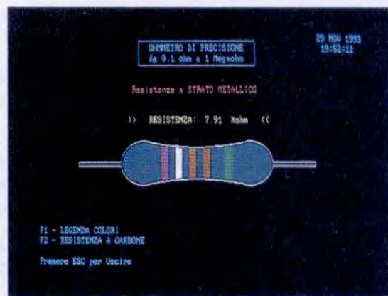
Fig.4 Quando misurerete delle resistenze a strato metallico, sul monitor appariranno una resistenza con cinque fasce di colore ed il suo valore ohmico senza la tolleranza.
